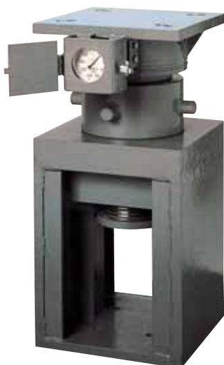
ニューキリンジャッキに土圧計をドッキングした荷重計付きニューキリンジャッキであります。切梁の軸力測定並びにアンダーパス等の上載荷重を正確に長期間でも計測する事が出来ます。
