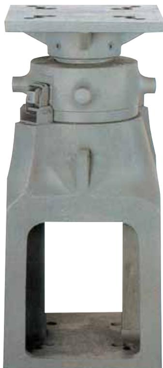
本器は従来の切梁長さ調整用に使用されているキリンジャッキの新型タイプであります。挿入ジャッキを使用する事により、単一的なプレロードが導入出来、又切梁の解体も挿入ジャッキ及び解体ジャッキの使用により、安全且つ迅速に切梁の解体作業が行えます。又アンダーパス、アンダーピニング工事等にも使用出来る簡易性、経済性とんであり御好評を得ております。
