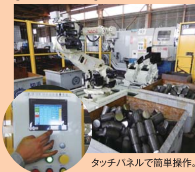
合計4tの材料を自動で連続切断できるため、手での流し作業が不要になった。
