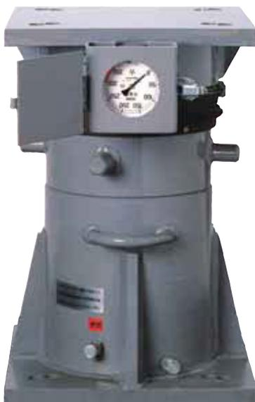
山留壁の側圧管理に、切梁の軸力を把握する必要があり、山留め架構全体の安全管理に不可欠な土圧測定器の採用として、油圧式土圧計を取り付けた荷重計付プレロードジャッキです。
