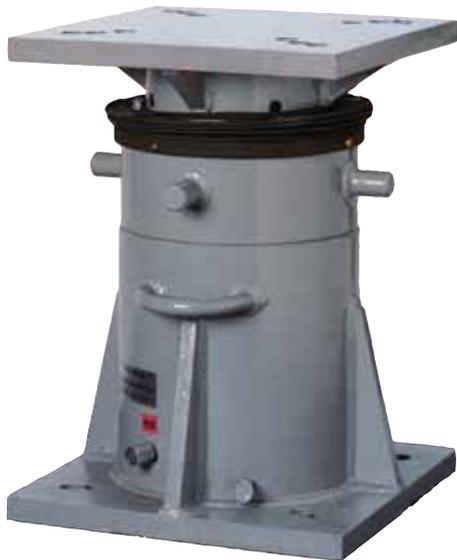
建築・土木建設の根切り、山留工事の切梁にプレロードを導入することにより、周辺地域の沈下を阻止し、山留架構の剛性を高め工事の安全性、経済性を確保するために開発されたロックナット付きオイルジャッキです。
