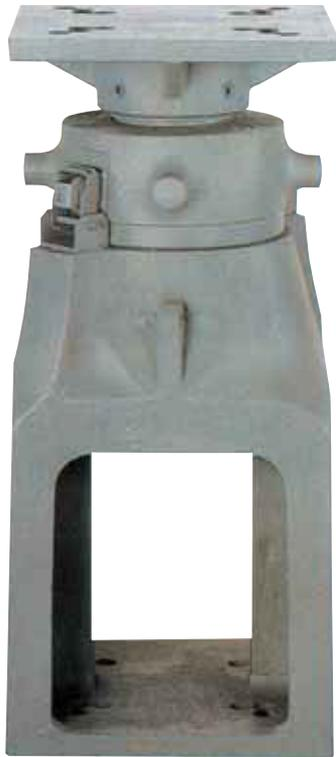
本器は従来の切梁長さ調整用に使用されているキリンジャッキの新型タイプであります。挿入ジャッキを使用する事により、単一的なプレロードが導入出来、又切梁の解体も挿入ジャッキ及び解体ジャッキの使用により、安全且つ迅速に切梁の解体作業が行えます。又アンダーパス、アンダーピニング工事等にも使用出来る簡易性、経済性にとんでおり御好評を得ております。
